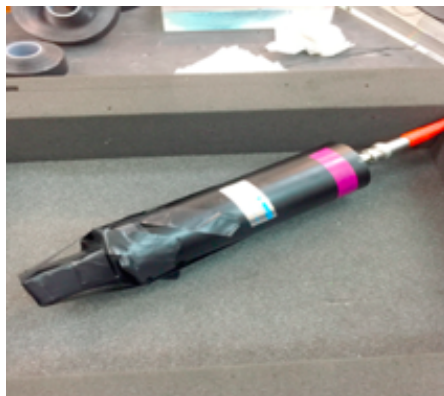
Figura 1: Centelleador de plástico recubierto y acoplado al PMT
