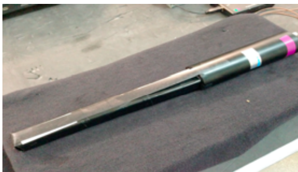
Figura 5: Centelleador de BGO recubierto y acoplado al PMT.
