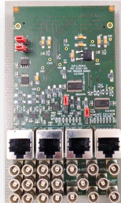
Módulo de FMC de entrada y salidas digitales (RD 50 y Física Médica)
