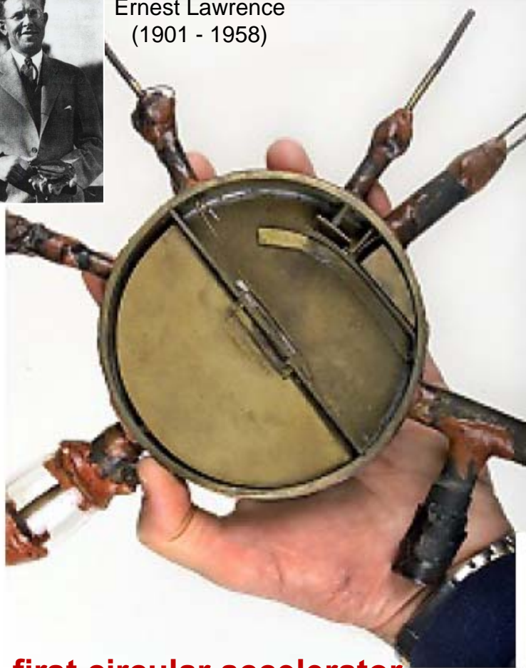
The first circular accelerator (Berkeley 1930)
