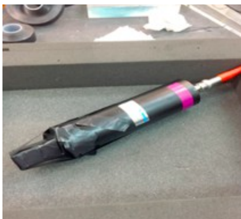
Figura 3: Centelleador de plástico acoplado al fotomultiplicador
