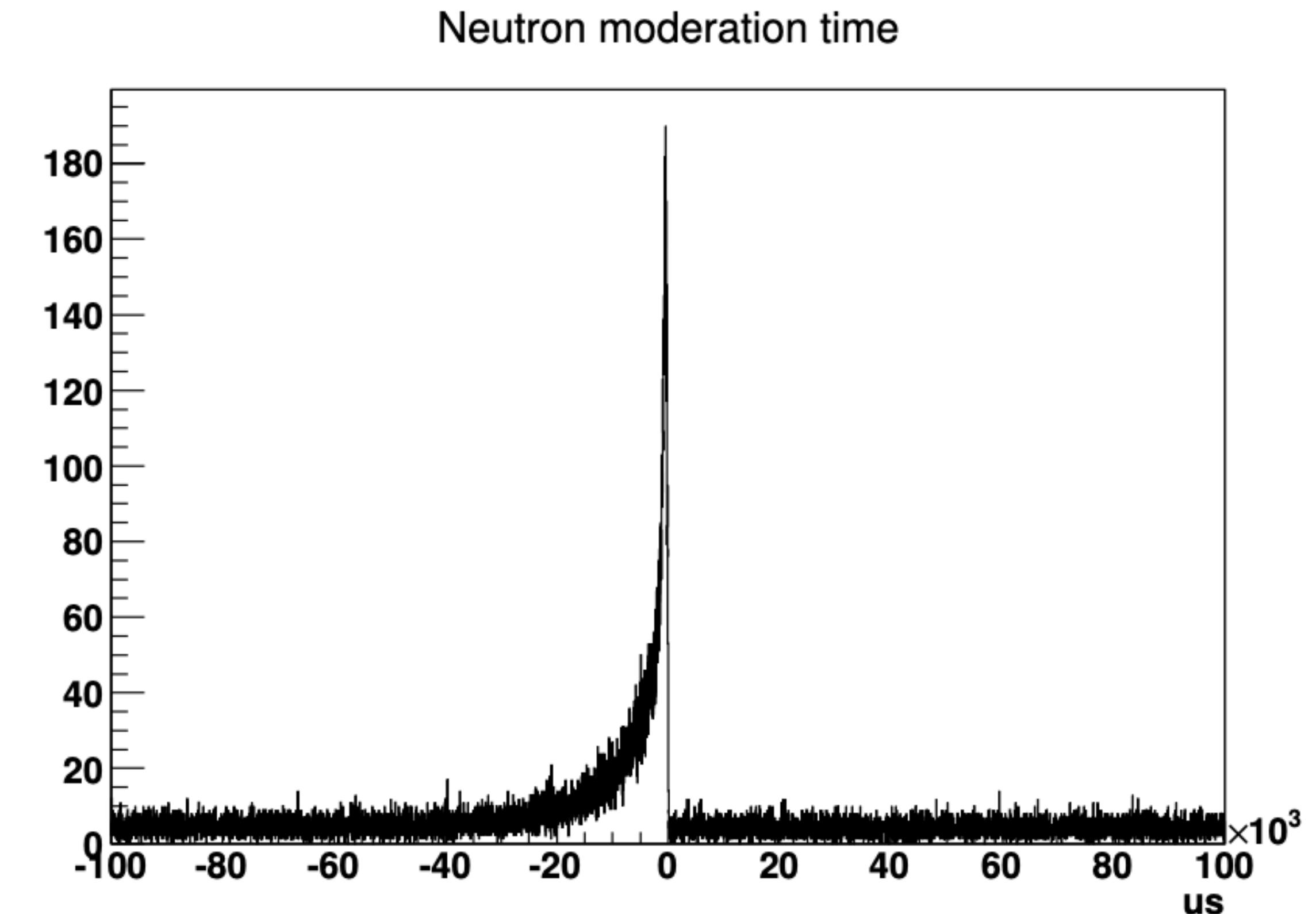
Tiempo relativo entre una detección de un beta y de un neutrón moderado
