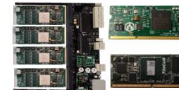
Itq. Sistema de estándar ATCA equipado con tarjetas de procesamiento de datos en FPGA con conexiones de fibra óptica de alta velocidad. Der. Módulos de formato compacto; Switch de comunicación GbE y System On-Chip para procesamiento de datos.
