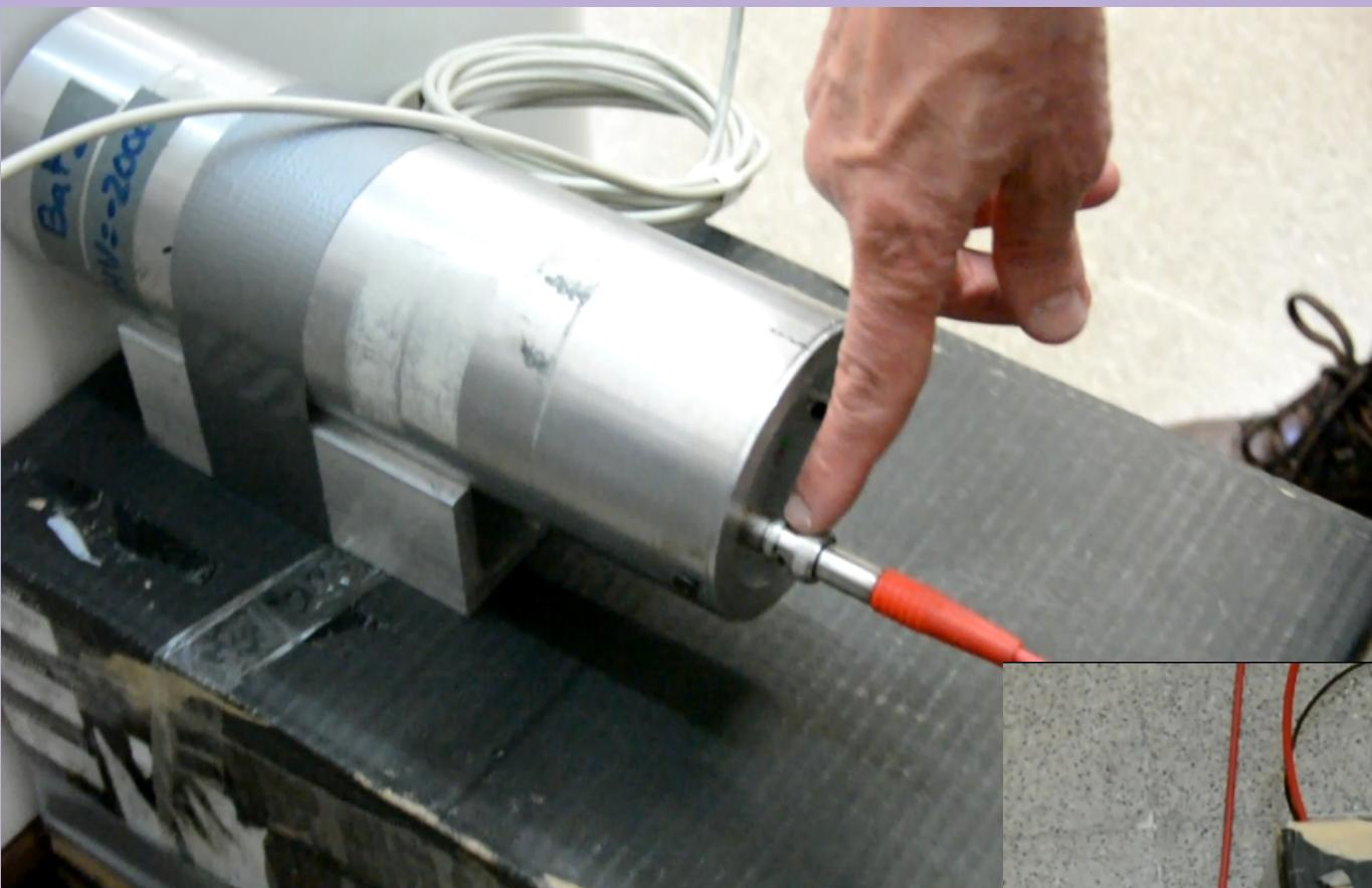
Colocacion del detector de BaF<sub>2</sub> y proteccion de la luz
