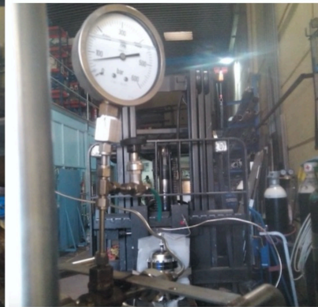
Figura-3: pruebas de presión de la vasija. (izquierda) la vasija con sus puertos amarrada para la prueba hidráulica de presión, (derecha) la vasija amarrada al fondo y el manómetro indicando 70 bar de presión. La presión de trabajo de la vasija es de 50 bar.
