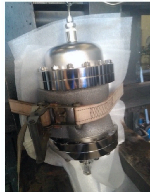
Figura-3: pruebas de presión de la vasija. (izquierda) la vasija con sus puertos amarrada para la prueba hidráulica de presión, (derecha) la vasija amarrada al fondo y el manómetro indicando 70 bar de presión. La presión de trabajo de la vasija es de 50 bar.
