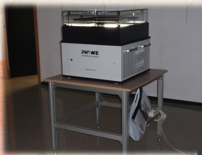
Cámara de niebla de difusión Lab IFIC 1ª Planta
