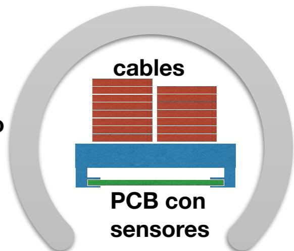
**Sistema de calibración de los sensores en Argón Líquido (88 k)**
