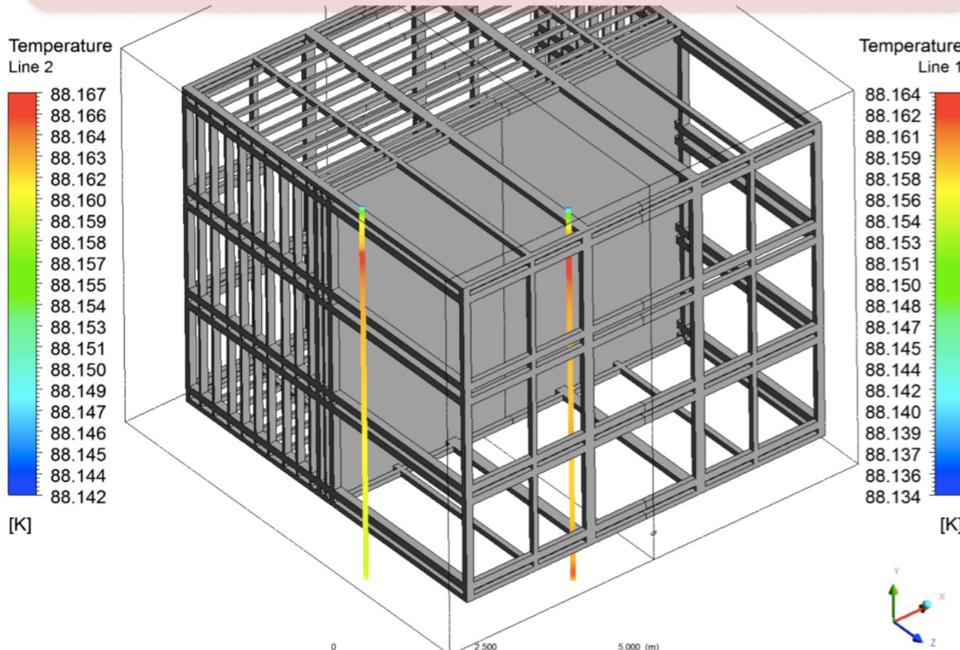
**Tubo de 7 m instrumentado con sensores de  $<0.01 \text{ k}$  de precisión cada 10 cm**
