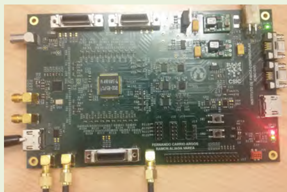
Test del primer prototipo de un buffer analógico integrado ASIC para las medidas de AGATA con detectores de partículas ligeras. IFIC – I3M UP – ETSE UV Servicio de Electrónica del IFIC
