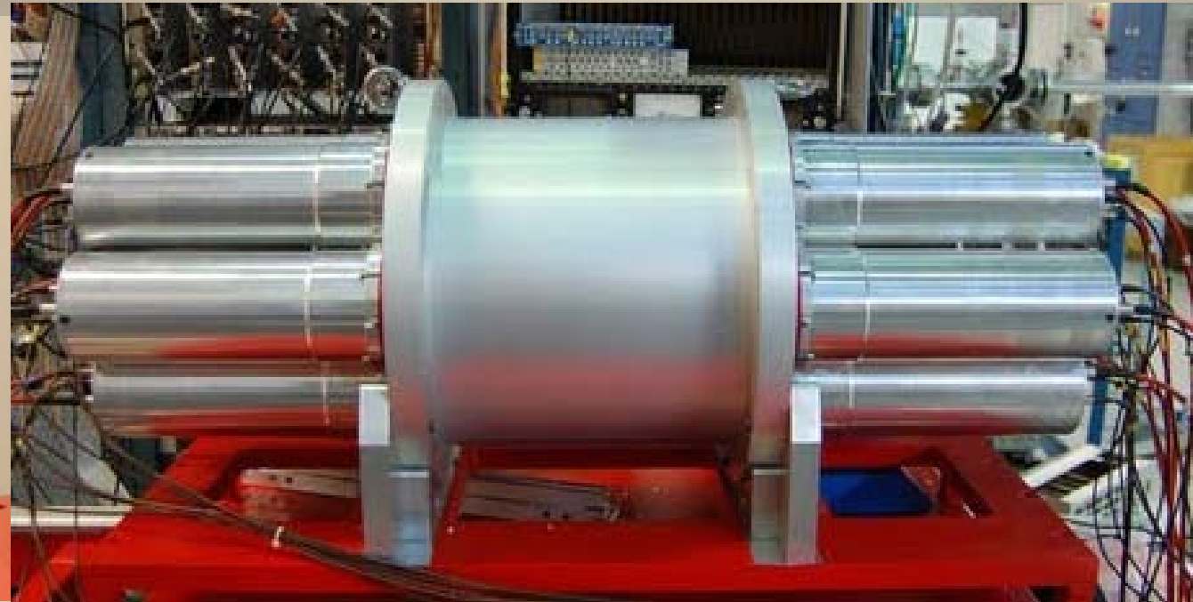
Segmented BaF2 Total Absorption Spectrometer “Rocinante” (Valencia-Surrey)
